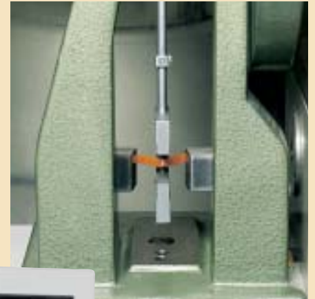
Pendelschlagwerk: Bestimmung der Schlag- und Kerbschlagzähigkeit
