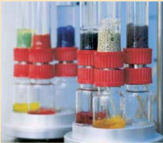
Apparativer Aufbau zur direkten Monomer- und Additivextraktion
