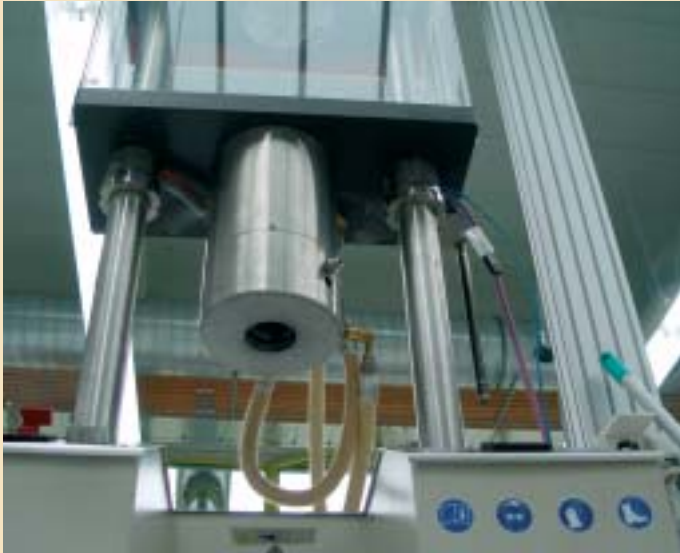
Kapillar-Rheometer: Ermittlung des Fließverhaltens einer Polymerschmelze und seiner Scherviskosität
