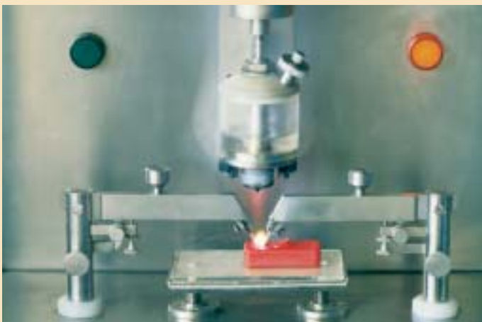
Bestimmung des CTI-Wertes (Comparative Tracking Index): Vergleichszahl der Kriechwegbildung, Prüfung im Rahmen der Elektrosicherheit
