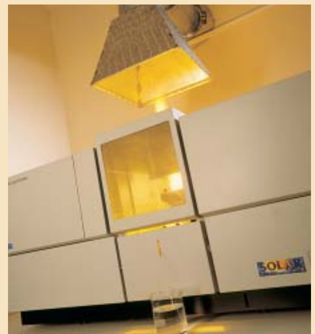
Atomabsorptionsspektrometer (AAS): Qualitativer und quantitativer Nachweis von Metallen im Spurenbereich
