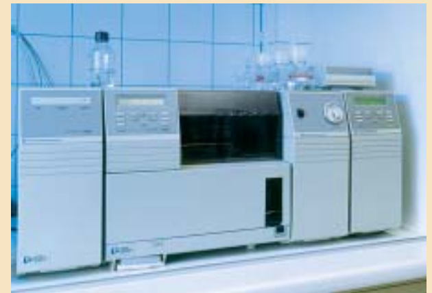
Hochleistungs-Flüssigkeitschromatographie (HPLC): Analyse auf Reinheit und Art der Additive
